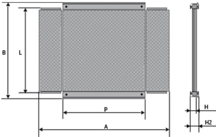
Durchfahrwaagen, mit genockter Struktur aus lackiertem Stahl. Ideal für das Wiegen von Wagen und Gabelhubwagen dank der Auf- bzw. Abfahrrampe auf beiden Seiten und den Seitenrändern. Standard-Version mit eichfähigen Wägezellen.
